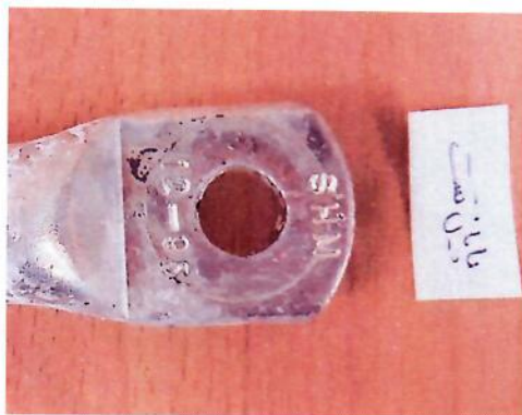
شکل ۶. بعد از باز کردن کابلشو از شینه مسی (پایان آزمون)
